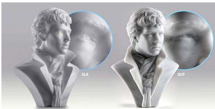
Рис. 1.6 Внешний вид распечаток SLA и DLP [4]
